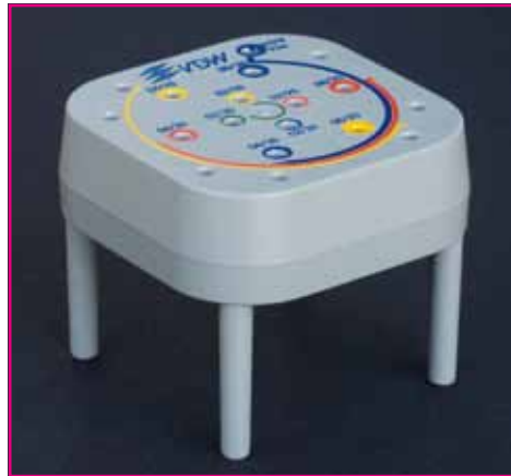
Durch die Aktivierung im Niederdruckplasma erhöht sich die Oberflächenspannung der Bohrermodule und es werden O-funktionelle Gruppen in die PE-Oberfläche eingebaut. Dadurch verbessert sich die Sterilisationsbeständigkeit signifikant.
