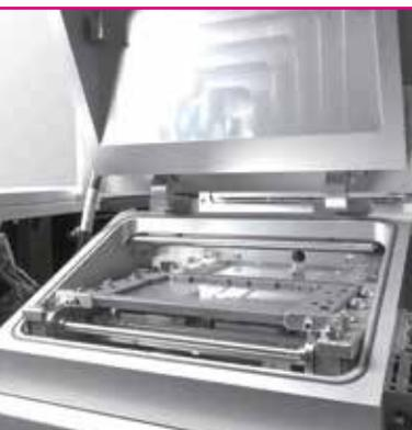
VADU100システムは、真空引きプロセスにより、少量生産においても高品質なボイドフリーハンダ接続を提供します。
