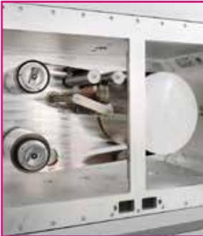
Die Rolle-Rolle-Anlage V240-2G ist für das Niederdruckplasma-Ätzen von feinsten Strukturen auf Kunststoff-Folien ausgelegt, kann aber auch zum Plasma-Aktivieren oder -Reinigen eingesetzt werden.
