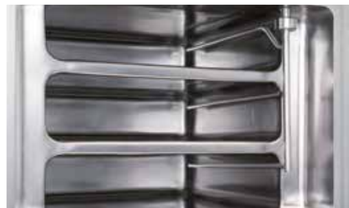
N 2 -Verteiler-Rechen: Senkrecht es Verteilerrohr mit Gasführungs-lanzen in jeder Beschickungskammer. Zum gezielten Einleiten von Gasen und zum Belüften der Kammer.
