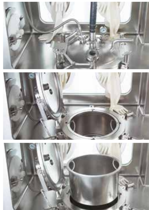
In den Isolator integrierte Drucknutsche mit herausnehmbarem Filtereinsatz.
