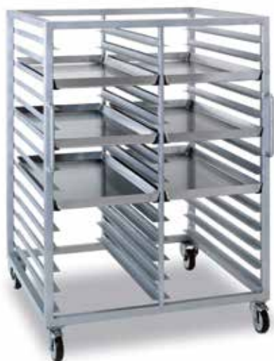
GMP-gerechte Komponenten: Beschickungswagen und Beschickungsschalen in Pharmaausführung (Rand mit umlaufender Neigung von 15° sowie geschliffenen und polierten Oberflächen).
