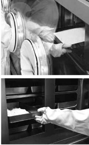
Das Trocknen von hochaktiven und toxischen Substanzen im Technikum, Labor oder in der Produktion erfordert Schutzmaßnahmen sowohl für den Bediener als auch für das Produkt. Deshalb hat PINK den Vakuum-Trockenschrank Typ VSD mit einem Isolator kombiniert, um das Handling von HAPI-Produkten sicher zu gestalten. Der VSDI eignet sich perfekt für die Trocknung dieser Substanzen.
