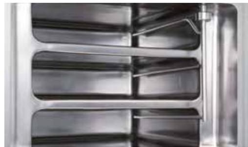
*N<sub>2</sub>-Verteiler-Rechen: Senkrechtetes Verteilerrohr mit Gasführungs-lanzen in jeder Beschickungskammer. Zum gezielten Einleiten von Gasen und zum Belüften der Kammer.*
