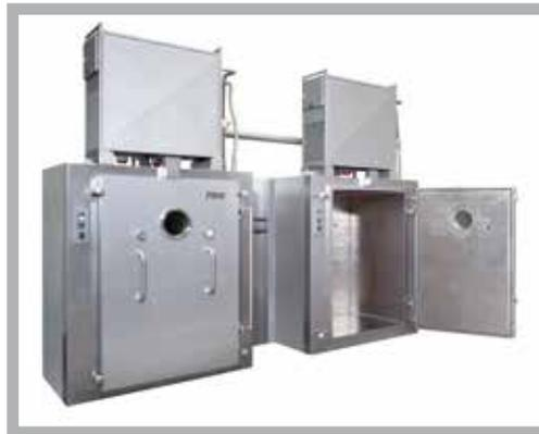
*Vakuum-Trockenschranke vom Typ VT in Durchreicheausführung mit Schleusenfunktion zwischen Reinraum und Grauraum. Die Chargierung erfolgt mittels Beschickungsgestell.*
