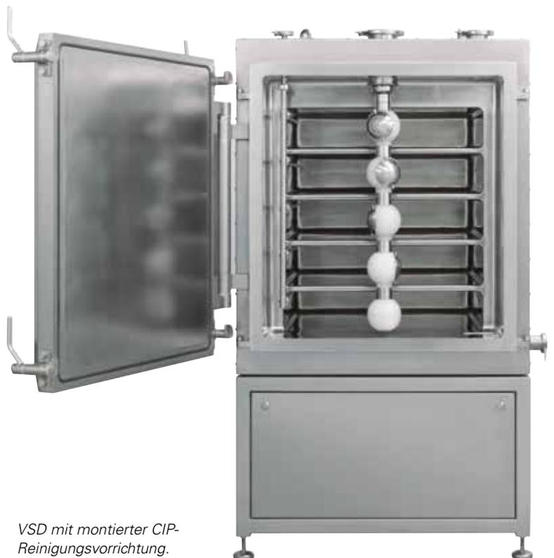
*VSD mit montierter CIP-Reinigungsvorrichtung.*
