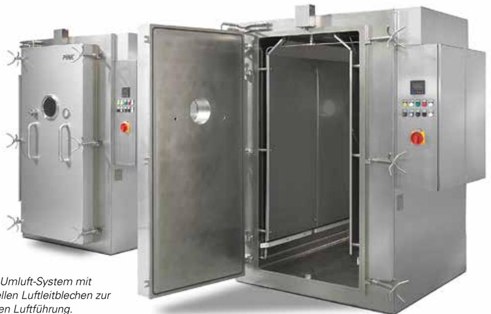
Vakuum-Umluft-System mit individuellen Luftleitblechen zur definierten Luftführung.
