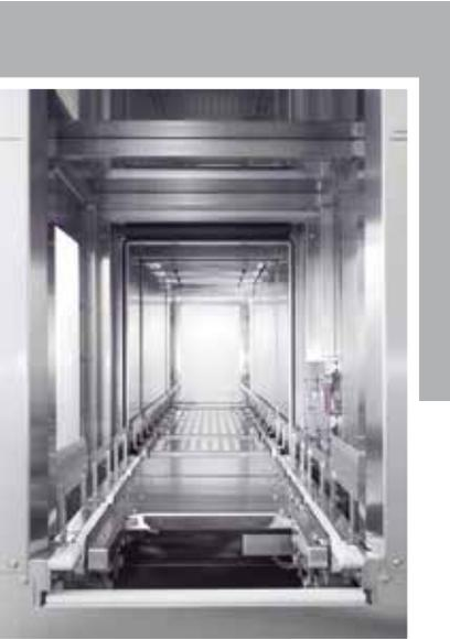
Inline-System mit Umluft-Heizzonen und einer Vakuum-Trocknungszone.
