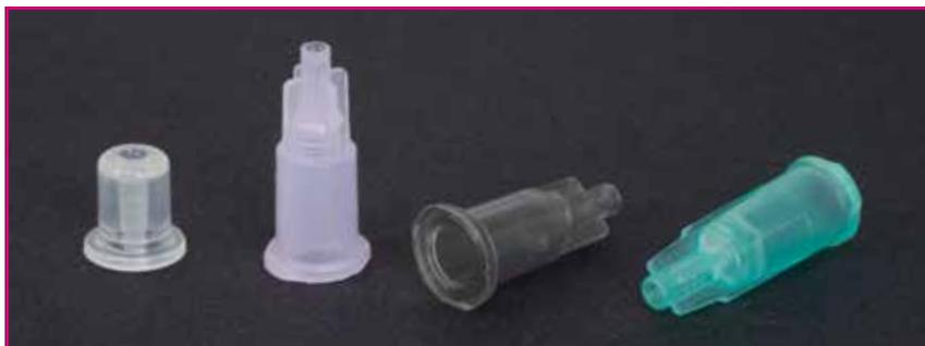
低圧プラズマによる表面活性化処理後には、シリンジハブの表面張力は改善され、ポリエチレン(PE)表面に酸素を含む官能基が導入されます。処理により、接着力が著しい強化されます。
