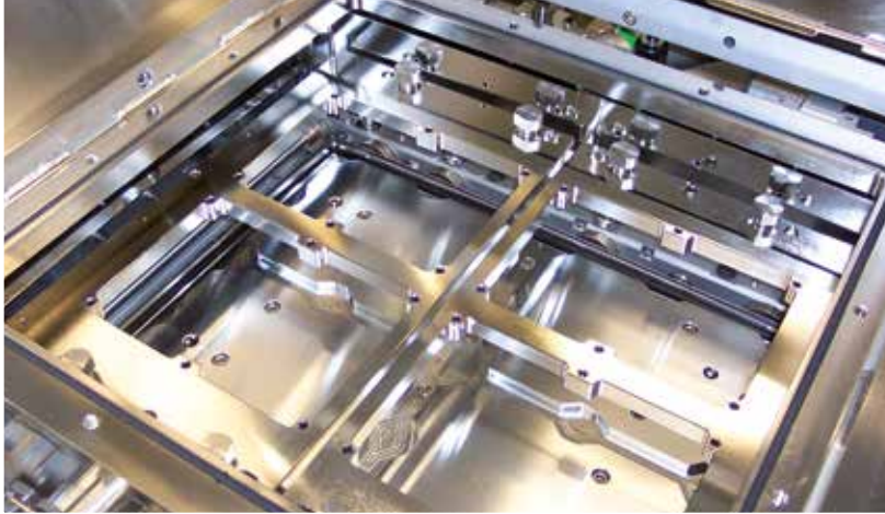
Werkstückträger mit integriertem Niederhalter-Rahmen für die automatische Fixierung in der Prozesskammer.
