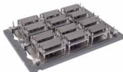
Werkstückträger mit Vorrichtungen zum Löten von Anschlusskontakten.
