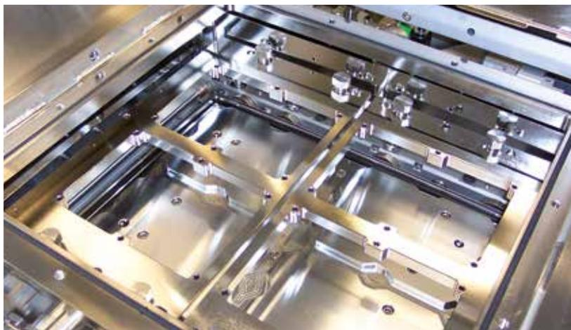
プロセスチャンパー内でのキャリアと自動固定用ダウンホルダーフレーム搭載例
