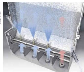
Kontinuierlicher Strahlschichtapparat zur gleichzeitigen Trocknung und Produktgestaltung
