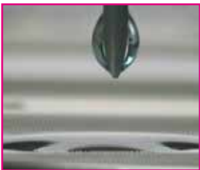
Abb. 3 und 4: Die Benetzbarkeit der Folie verbessert sich nach der Plasmareinigung signifikant.
