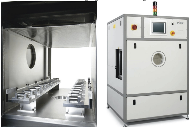
Bild 6: Vollständig automatisierte V200-2G-Inline-Anlage zur Behandlung von Zündspulen sowie Blick in deren Plasmakammer. (Bild: PINK)
