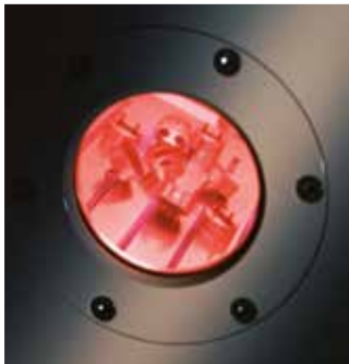
高度洗浄プロセス処理中の真空プラズマ装置のプラズマ室の様子
