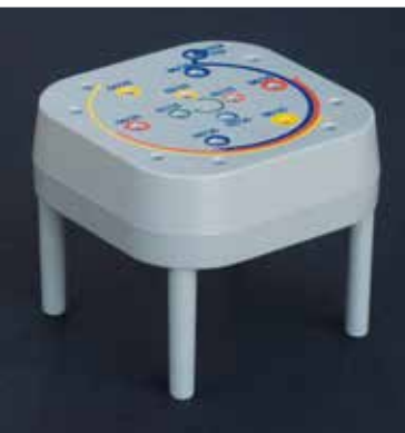
真空プラズマで表面活性化が行われることで表面張力が増加し、酸素を含む官能基がPE材表面に導入された。この改質により印字の接着性が改良された。
