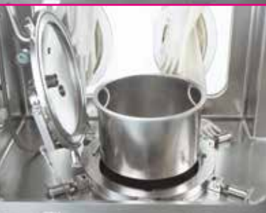
In den Isolator integrierte Drucknutsche mit herausnehmbarem Filtereinsatz.
