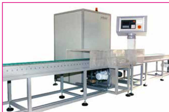
Plasmaanlage V138-G zur Behandlung von Kondensatoren.
