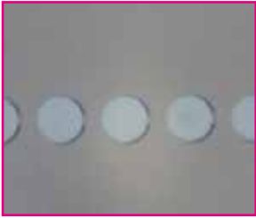
図1と2 レーザードリルで穴をあけた周りの残渣の除去状況
