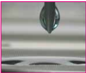
図3と4 プラズマ処理後のフィルムの親水特性の著しい変化
