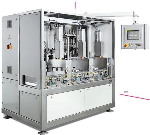
Die neu modifizierten VADU: modularer Aufbau mit integriertem Schaltschrank
