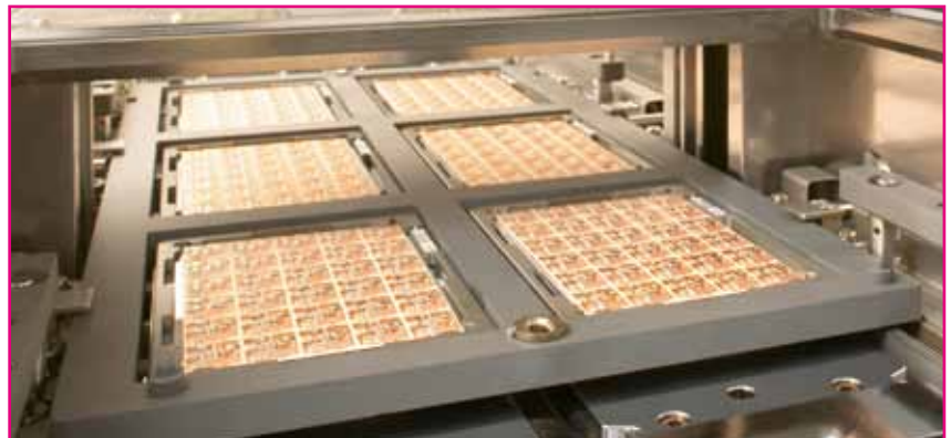
Werkstückträger mit Baseplates und Großkarten 5 x 7".
