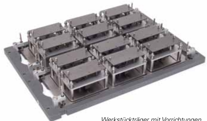
Werkstückträger mit Vorrichtungen zum Löten von Anschlusskontakten.
