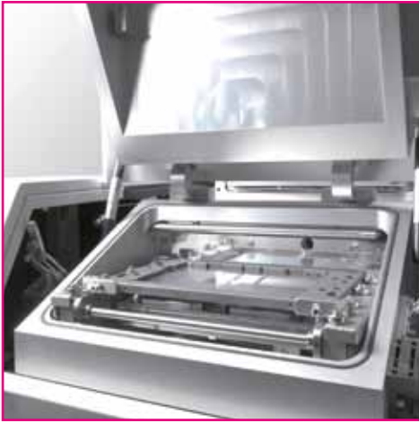
Die VADU 100 ist mit separaten Prozesszonen für das Löten und Kühlen ausgestattet.
