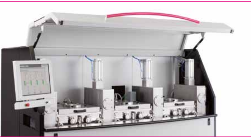
Inline-Lötanlage VADU300 mit drei separaten Prozesskammern zum Vorheizen, Löten und Kühlen.
