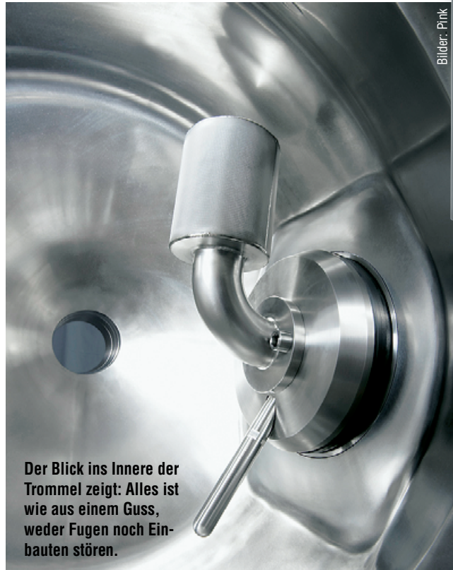
Die Trocknertrommel des RTSD rotiert fliegend um eine feststehende Achse.
