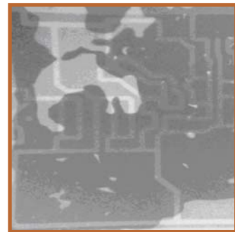
■ Lötgergebnisse ohne Vakuum: Lunkeranteil >15% (oben) und mit Vakuum: Lunkeranteil <1% (unten)
