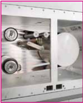
Blick in die Behandlungskammer mit Plasmaquelle und Wickelmechanismus.
