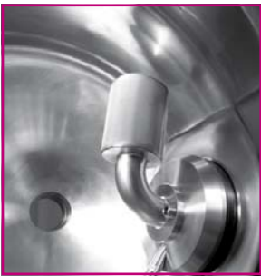
GMP- gerechter Innenraum der Trommel mit Filter und Produkttemperaturfühler.
