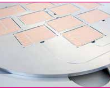
Beispiel eines Sinter-Werkstückträgers für Einzelsubstrate.
